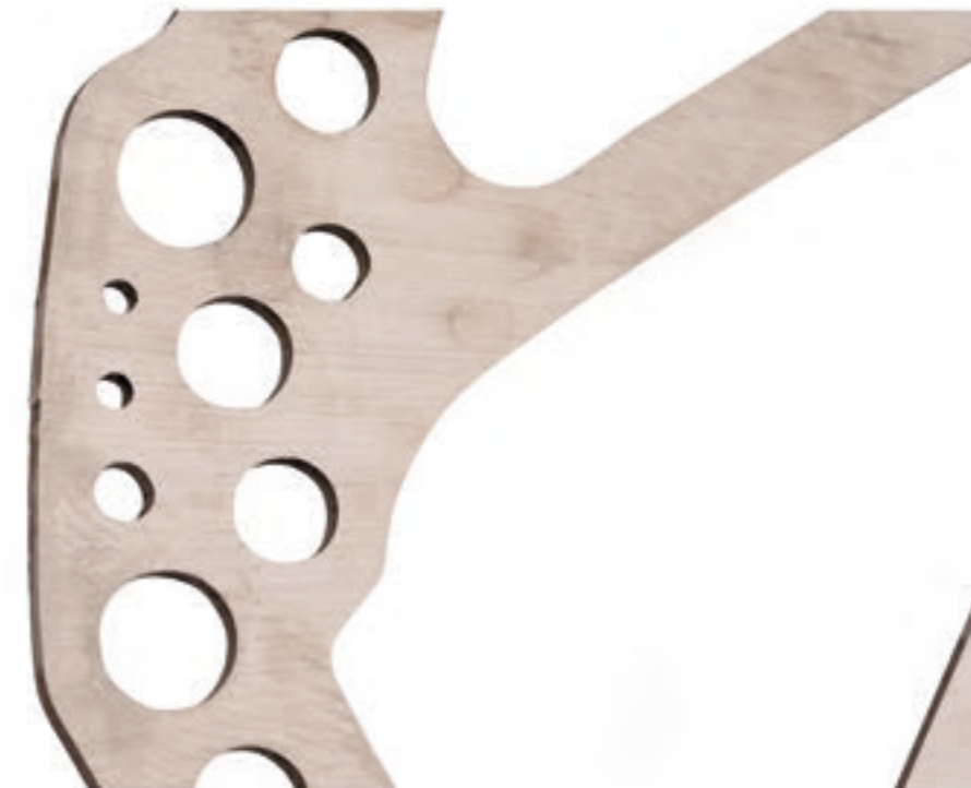
DISQUE NON RODÉ, MARQUES DE RECTIFICATION TOUJOURS VISIBLES
